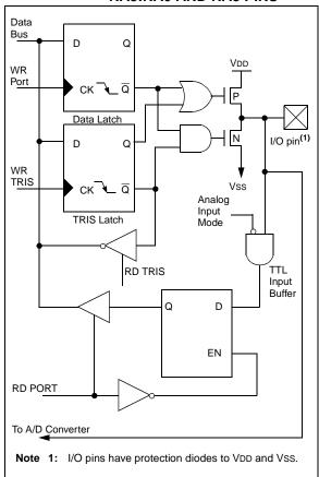
FIGURE 3-2: BLOCK DIAGRAM OF RA4/ TOCKI PIN
