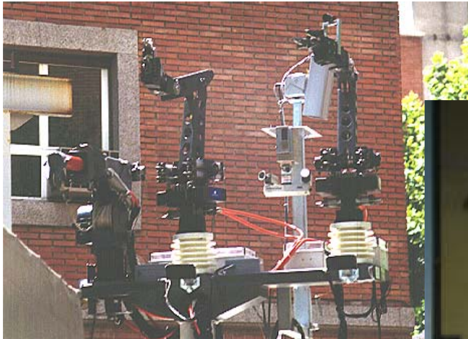
ROBTET: robot para mantenimiento de torres de alta tensión: UPM/Iberdrola/Cobra
