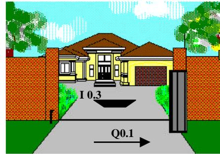
Cuando se accione el pulsador de apertura de puerta, la puerta se abre (si no estaba abierta) y cuando el vehículo se encuentra en el interior del recinto y presiona el sensor de paso la puerta se cierra.
