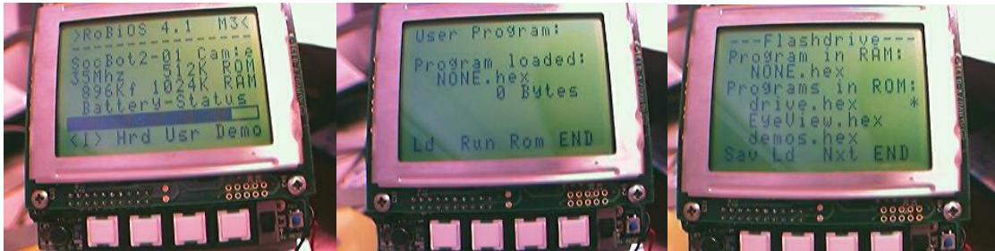
Figura 6. a) pantalla de inicio, b) gestor de programas c) programas en ROM
