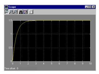
Para simular el sistema discreto se va a utilizar el bloque '*Discrete Transfer Fcn*' de la librería '*Discrete*'. En este bloque se especifica la función de transferencia discreta indicando el vector de coeficientes del numerador y el del denominador, así como el periodo de muestreo:
