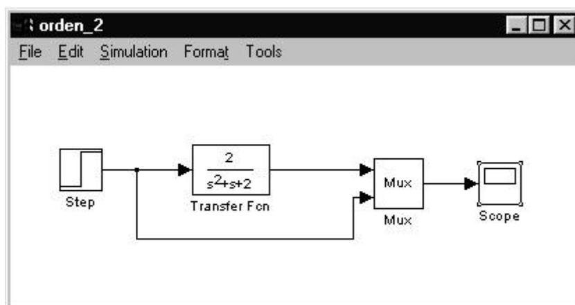
En este esquema hay algo nuevo que aún no sabemos hacer: cómo crear una rama nueva sobre una conexión ya existente (la segunda rama que llega al multiplexor no parte de la salida de un bloque, sino de un punto intermedio de una conexión). La forma de crear este tipo de conexiones es pulsando el botón '**Ctrl**' al mismo tiempo que se empieza a arrastrar con el ratón.
