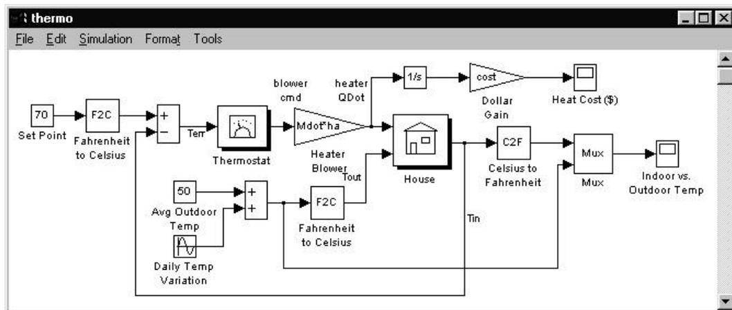
El esquema anterior representa un sistema de calefacción para una vivienda. Se supone conocida la variación de la temperatura en el exterior de la casa y en función de ello se puede observar en qué instantes se conecta y se desconecta la calefacción, cuáles son las variaciones de la temperatura en el interior de la casa y cuál es el coste de calefacción. Este ejemplo proviene de una *demo* de Simulink y será analizado más adelante.
