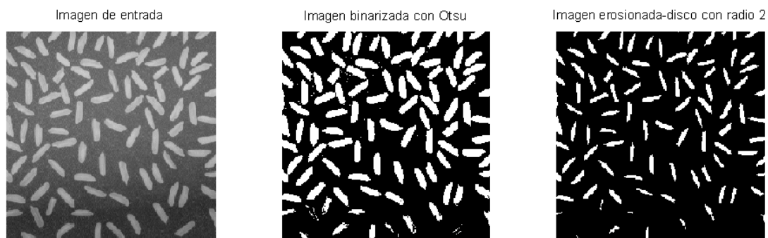
Figura 6. 2 a) Imagen original, b) Imagen segmentada, c) Imagen erosionada con elemento estructurante tipo disco de radio 2
