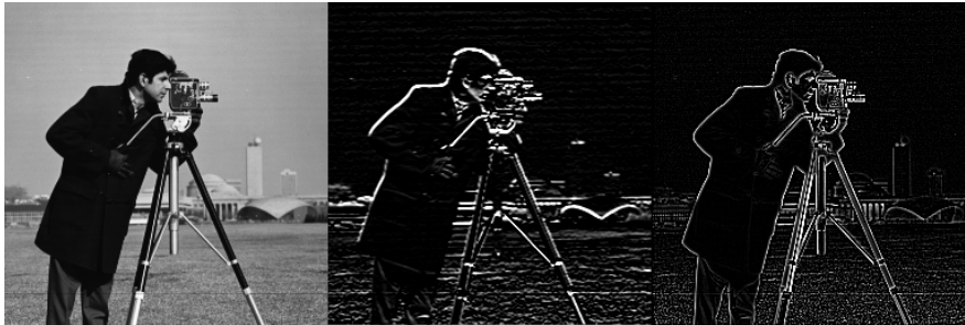
Imagen de entrada y sus procesamiento con Sobel y con laplaciana de Gauss
