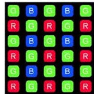
Figura 2. 50. 1CCD con filtro de Bayer
