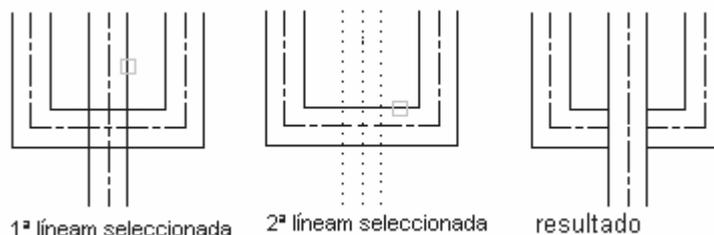
2. Crea una intersección en cruz abierta entre dos líneas múltiples. AutoCAD parte todos los elementos de la primera línea múltiple y solamente los elementos externos de la segunda línea múltiple.
