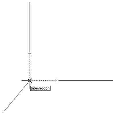
Buscamos el punto de intersección entre la vertical y la horizontal del rastreo hasta que aparezca [intersección]. Ya lo tenemos, solo tenemos que hacer clic y ya está... Ni una sola @, ni una sola línea auxiliar, ni un solo clic, muy rápidamente.
