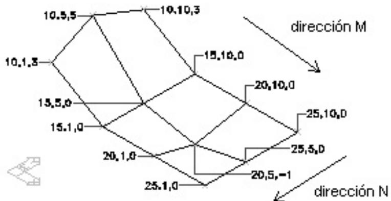
Como en el caso de PCARA la realización de caras mediante esta opción es muy trabajosa, por lo que está orientada a ser utilizada en programación en AutoCAD.
