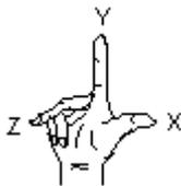
Para determinar la orientación positiva de los ejes X, Y y Z, situamos el dorso de la mano derecha cerca de la pantalla. Se señala con el dedo pulgar en la misma dirección que marca el eje X positivo. A continuación, se extiende el índice y el corazón, tal y como se aprecia en el dibujo, y se dirige el índice en el mismo sentido que el eje Y positivo. Se señala con el dedo corazón en la misma dirección que marca el eje Z positivo.
