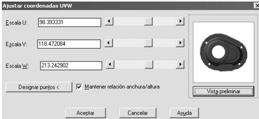
**Escala U, V, W:** Determinamos el valor de la escala en los ejes U, V, W como coordenadas de proyección en 3D.
