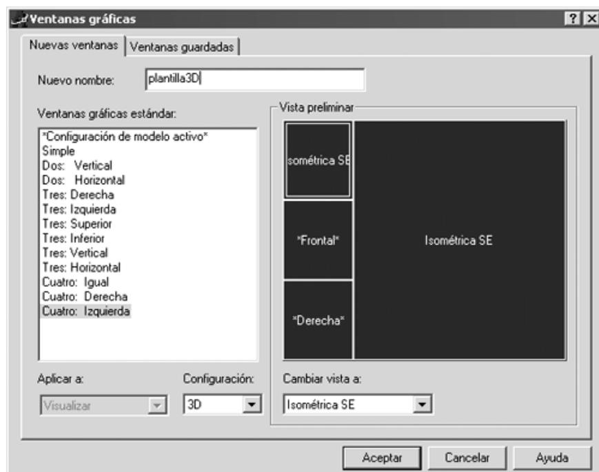
Antes de seguir, fijémonos en algo. A diferencia de AutoCAD® 14, cada ventana tiene su propio SCP que puede ser modificado independientemente. Es decir el plano de trabajo se puede configurar y modificar por separado en las ventanas creadas. La ventaja es evidente, ya que no tendremos que cambiar continuamente de plano para trabajar en las diferentes ventanas. Esta opción se puede activar o desactivar rápidamente desde la ventana de *propiedades* en la opción *Varios -> SCP por ventana*.
