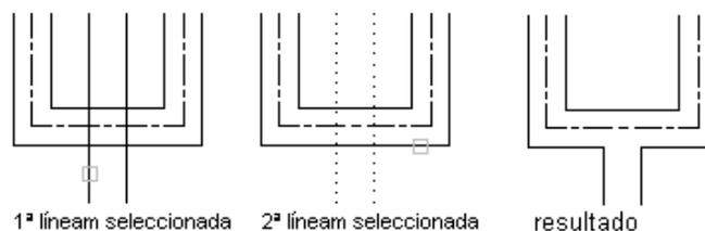
6. Crea una intersección de fusión en T entre dos líneas múltiples. AutoCAD recorta o extiende la línea múltiple en su intersección con la otra línea múltiple.
