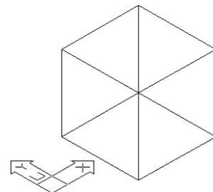
**Estructura alámbrica 3D:** Muestra los objetos utilizando líneas y curvas para representar los contornos. Muestra el icono de SCP 3D sombreada. Los objetos de trama y OLE así como los tipos y grosores de línea no se ven. Aparecen los colores de materiales que se han aplicado a los objetos.
