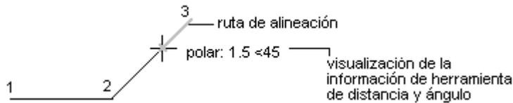
Puede utilizar el rastreo polar para realizar un rastreo a lo largo de incrementos de ángulos polares de 90, 60, 45, 30, 22.5, 18, 15, 10 y 5 grados, pudiendo precisar otros ángulos.
