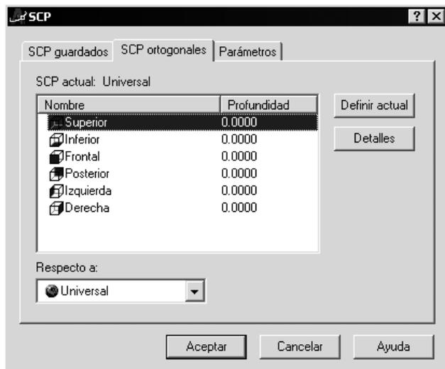
lista *Respecto a*. El campo *Profundidad* muestra la distancia entre el sistema de coordenadas ortogonales y el plano paralelo que pasa por el origen del parámetro de base de SCP. Por ejemplo, para situarnos en la ‘tapa’ de un cubo de altura 10, podremos elegir el SCP Superior a una profundidad de 10, suponiendo el origen de coordenadas (que determina el plano XY de coordenada Z=0) en la base del cubo.
