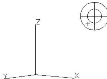
**Precise un punto de vista:** Podemos, por otra parte, introducirlo de forma numérica. Por medio de las coordenadas X, Y, Z introducidas, se crea un vector que define una dirección desde la que puede mirarse el dibujo.
