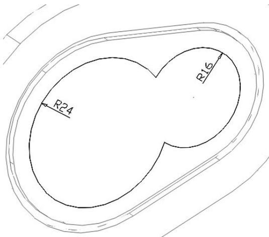
*Ejercicio:* Inténtalo tú. Debes situar el *SCP* adecuado para poner el plano XY en la cara del perfil. Luego dibujar los dos *círculos* (sus centros están en los centros de los círculo exteriores). Luego *recorta* la parte sobrante y convierte el perfil en *región*.
