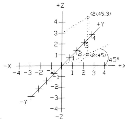
**Coordenadas esféricas:** Se introduce la distancia, ángulo respecto al ángulo XZ y ángulo de elevación o altura a partir del plano XY. Por ejemplo **20<45<20**.
