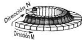
Una vez seleccionado el perfil y el eje AutoCAD precisa el ángulo de inicio y de fin de esa revolución.
