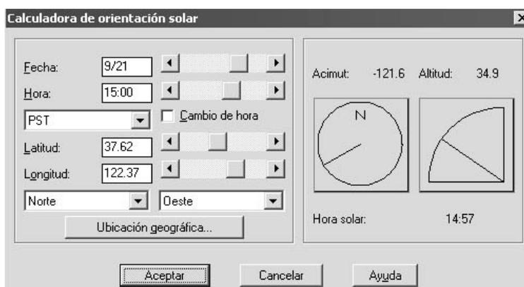
**Calculadora de orientación solar...** Mediante este sistema podemos determinar la posición del sol en un lugar, día y hora concreta. Introduciendo la **Fecha, Hora, el horario**
