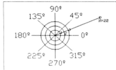
**Coordenadas cilíndricas:** Son idénticas a las polares en el plano XY salvo que añadimos la coordenada Z. Se introduce la distancia, ángulo sobre el plano XZ y la distancia vértices respecto al plano XY, es decir, la altura. Por ejemplo **50<50,30**.
