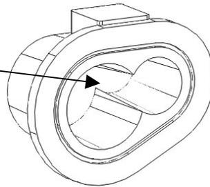
Giramos la pieza con la *Órbita 3D*, situamos el SCP en la cara circular posterior y dibujamos un círculo de radio 16 sobre ésta, para conseguir...
