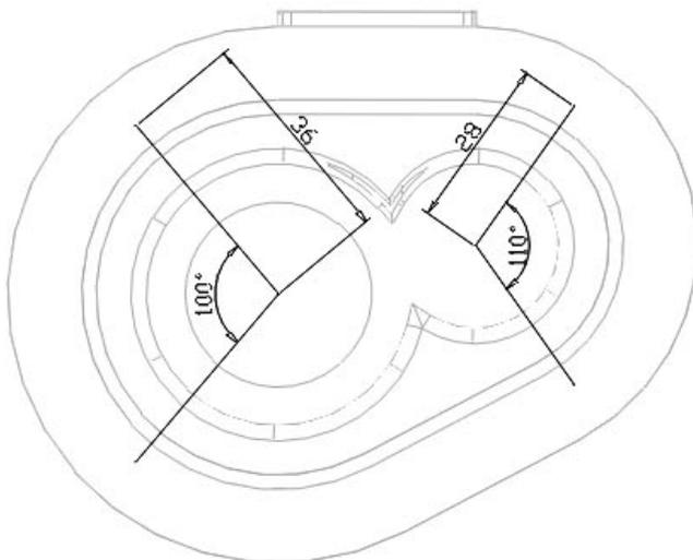
**Ejercicio:** Dibújalas, para ello utiliza las herramientas: *Línea*, *Girar*, *Simetría*. La idea es crear primero una línea horizontal de longitud adecuada, luego la giramos un cierto ángulo ( $50^\circ$  o  $55^\circ$  según sea el caso), para después hacer una simetría respecto la horizontal y obtener la otra línea.
