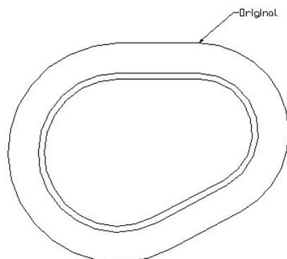
Crearemos por comodidad una nueva capa llamada *AUX* donde colocaremos la polilínea más exterior y interior. Desactivaremos ésta capa ‘apagando la bombilla’ y así sólo tendremos la polilínea intermedia en pantalla.
