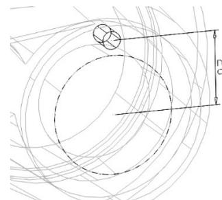
del agujero de 20, como muestra la figura. Lo más importante en este caso es situar los ejes bien. Puedes utilizar el rastreo polar para situar el centro del círculo. Luego extrusiona el perfil con una altura de 8.
