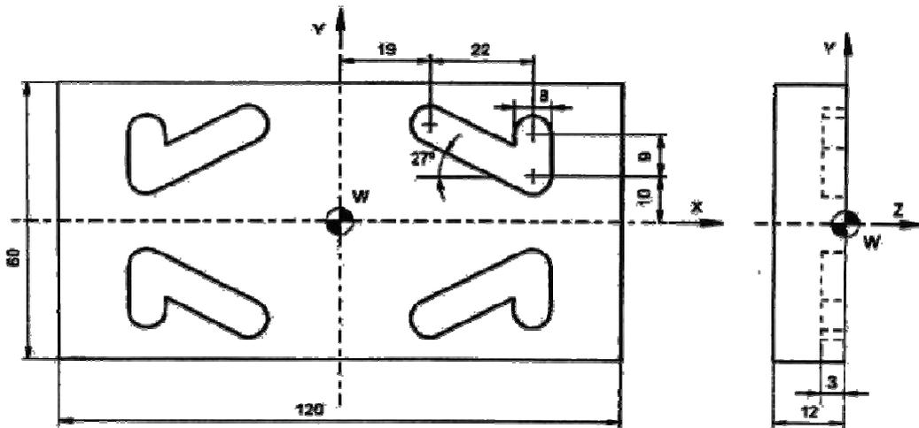
10. Utilizando los ciclos fijos de fresado, programar el taladrado de los agujeros representados en la siguiente figura. La herramienta tiene un diámetro de 8 mm. La velocidad de corte recomendada para el material es de 65 m/min. El avance es de 0.16 mm/rev.
