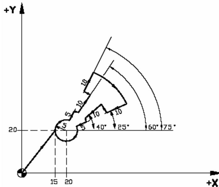
5. Dado el siguiente código de control numérico, y teniendo en cuenta que la herramienta 1 tiene un radio de 5 mm, dibujar la geometría que se consigue tras la ejecución del programa y la trayectoria seguida por el centro de la herramienta. (Inicialmente, la herramienta está en (0,0)).
