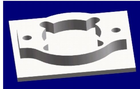
12. Realizar el mecanizado de los vaciados entre los brazos de la polea. Herramienta, fresa de 10 mm de diámetro, 2 labios. Velocidad del husillo de 750 rpm y avance de 25 mm/min en vertical y 75 mm/min en el plano horizontal.
