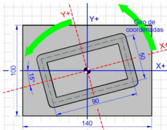
9. Utilizando las funciones imagen espejo, realizar el mecanizado de las ranuras de la figura. La herramienta tiene un diámetro de 6 mm y 3 labios. La velocidad de corte recomendada para el material es de 40 m/min, y el avance por diente de 0.022 mm.
