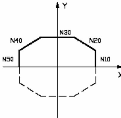
2. Dado el siguiente código de control numérico, y teniendo en cuenta que la herramienta 1 tiene un radio de 10 mm, dibujar la geometría que se consigue tras la ejecución del programa y la trayectoria seguida por el centro de la herramienta. (Inicialmente, la herramienta está en (0,0)).
