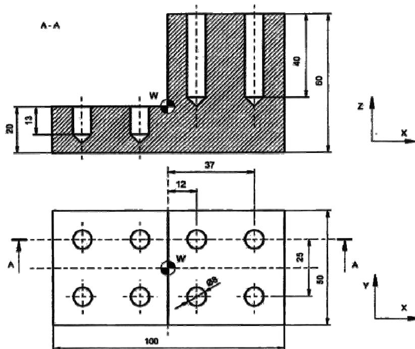
11. Realizar el mecanizado del contorno exterior y del vaciado de la figura. Se utilizará una fresa de 10 mm de diámetro y 2 labios. La velocidad de corte será de 1200 rpm y el avance de 60 mm/min.
