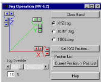
El botón **Current Position->Pos.List** permite ir creando una lista de posiciones válidas del robot siguiendo un método de programación manual.
