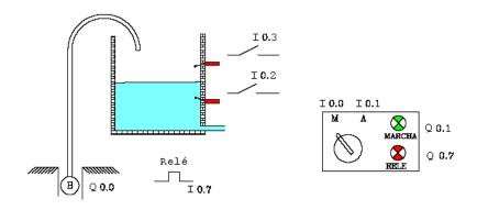
Para manejar el depósito disponemos de un selector de mando. Podemos seleccionar modo manual o modo automático:
