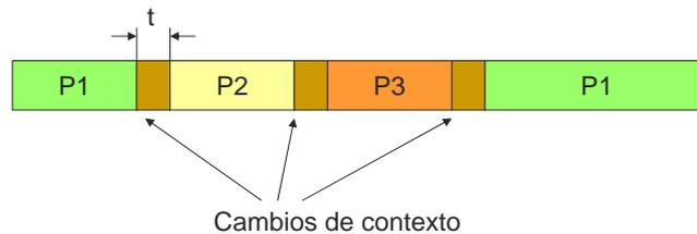
$$Utilizacion = \frac{T(P1)+T(P2)+T(P3)}{T(P1)+T(P2)+T(P3)+3t}$$
