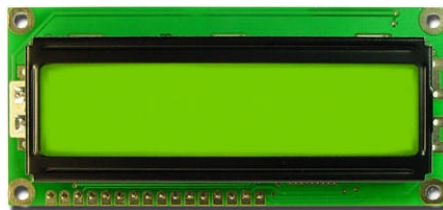
Figura 1. LCD 2x16: está compuesto por 2 líneas de 16 caracteres
