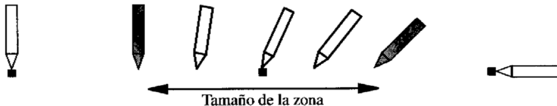
Figura 4 Si la posición del medio fuera un punto de paso, la ejecución del programa tendría este aspecto
