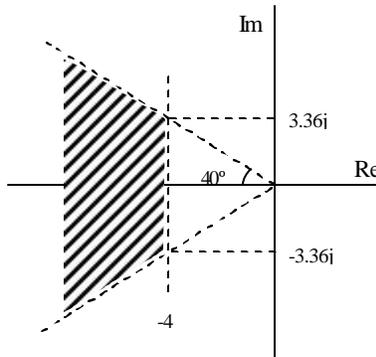
A continuación se prueba con el más sencillo de los reguladores, el proporcional [C(s)=K]. Este regulador será válido si el LDR del sistema pasa por la zona válida. El trazado de este LDR es muy simple:
