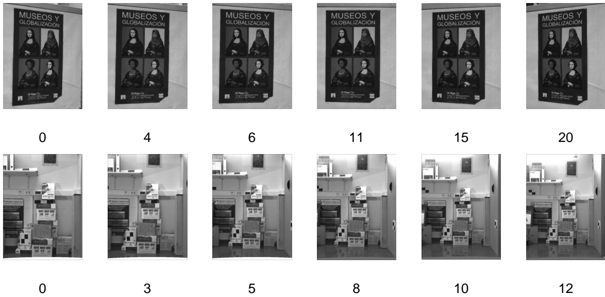
Figura 3.6: La secuencia superior muestra un objeto plano (un póster) observado desde diferentes puntos de vista. La secuencia inferior muestra una escena tridimensional con cambios en la distancia a la cámara.
